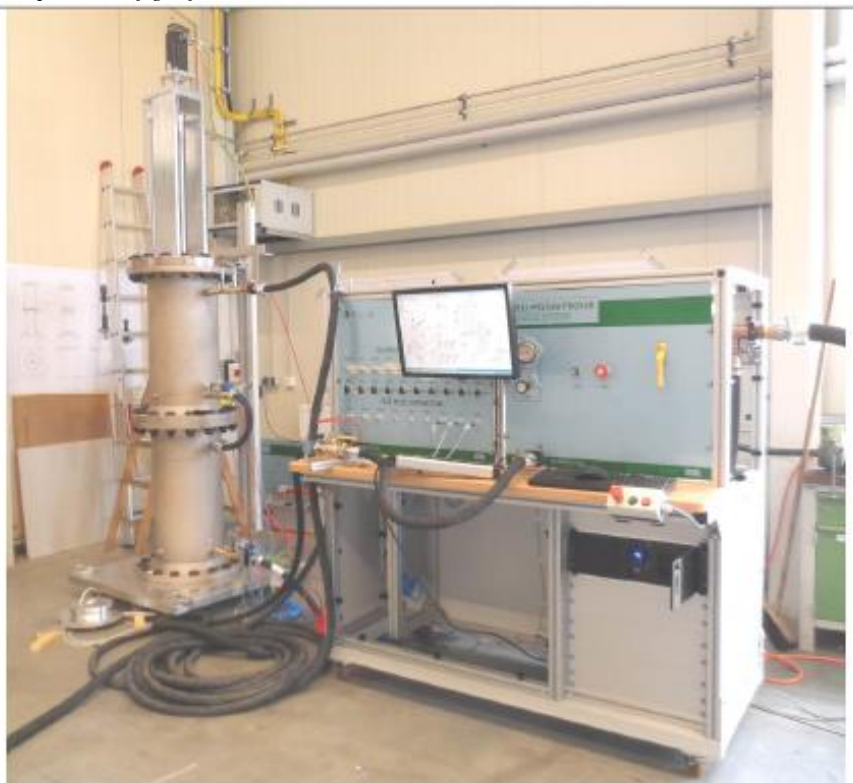
Рисунок 6 - Внешний вид первичного эталона Bell Piston Prover DN 400.
