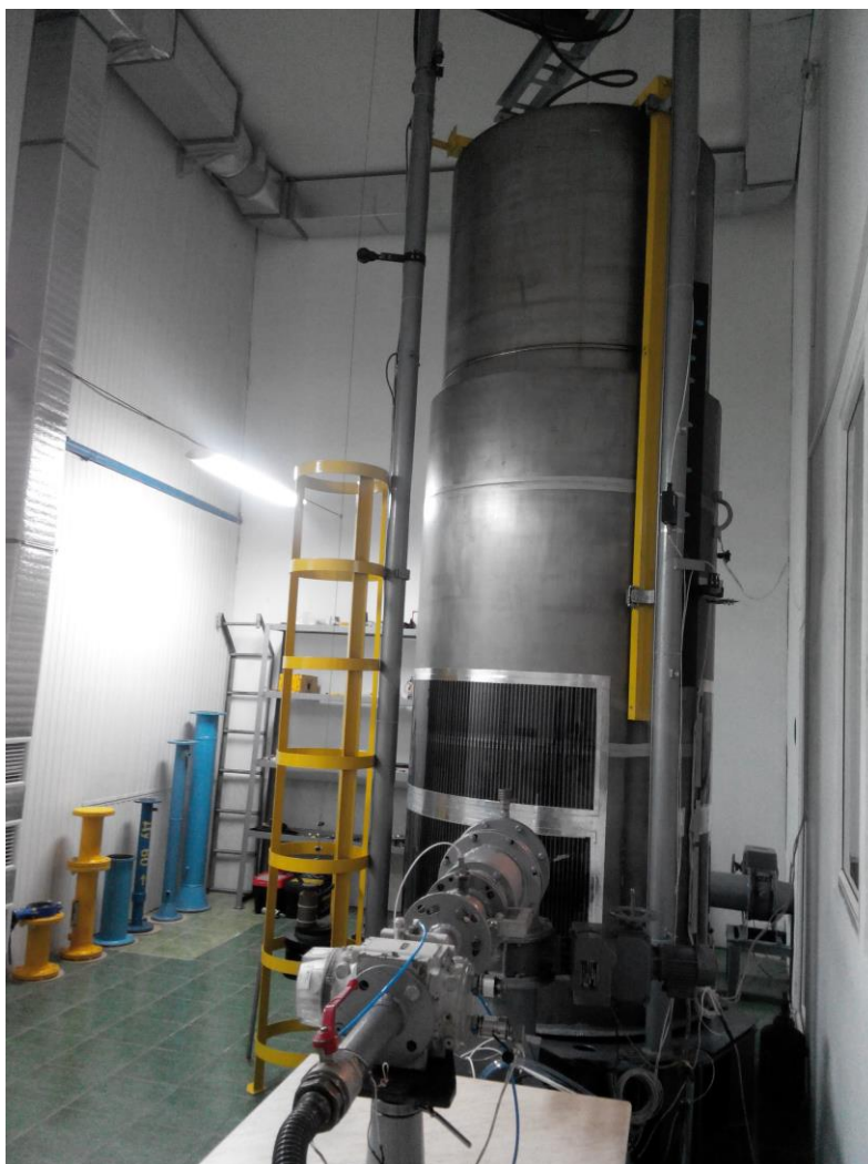
Рисунок 4 – Внешний вид Государственного первичного эталона единиц объема и объемного расхода газа из сличаемым средством измерения Delta S-Flow
