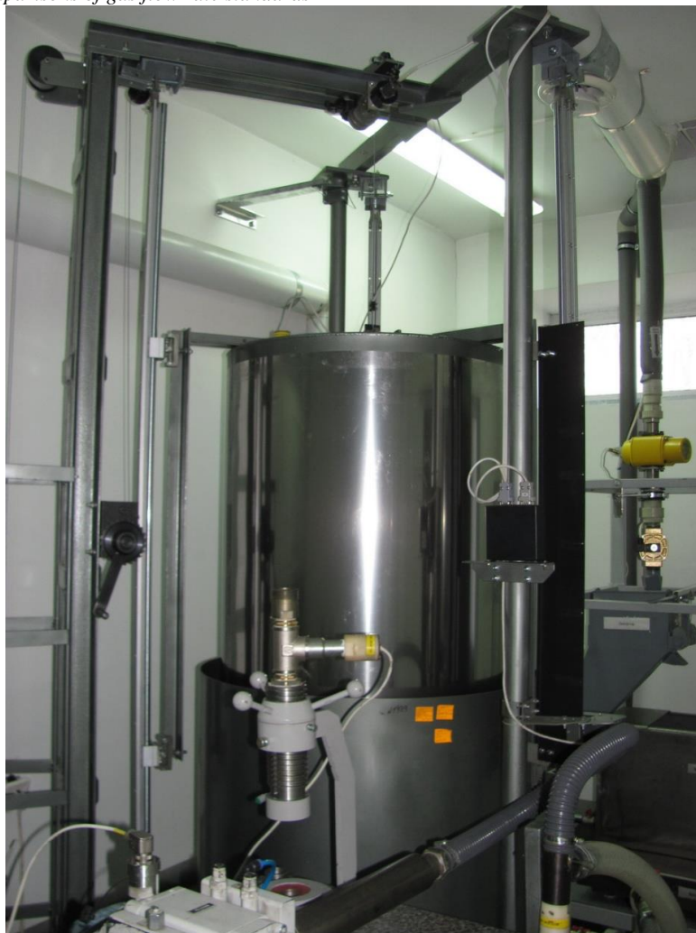
Рисунок 5 - Общий вид вторичного эталона единиц объема и объемного расхода газа ВЕТУ 03-01-01-15.
